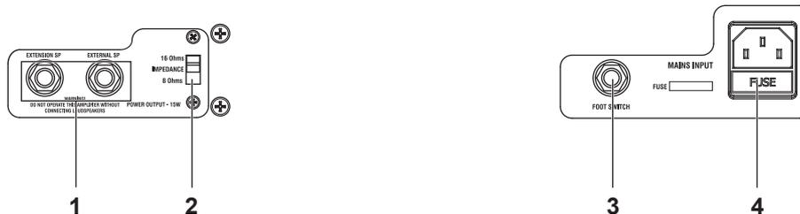
**EXTENSION SP:** Eine hier angeschlossene Box wird parallel zu den internen Lautsprechern getrieben (16Ω). Die Impedanz der externen Box muss zwar 16Ω lauten, aber der IMPEDANCE-Schalter muss auf „8Ω“ gestellt werden.
