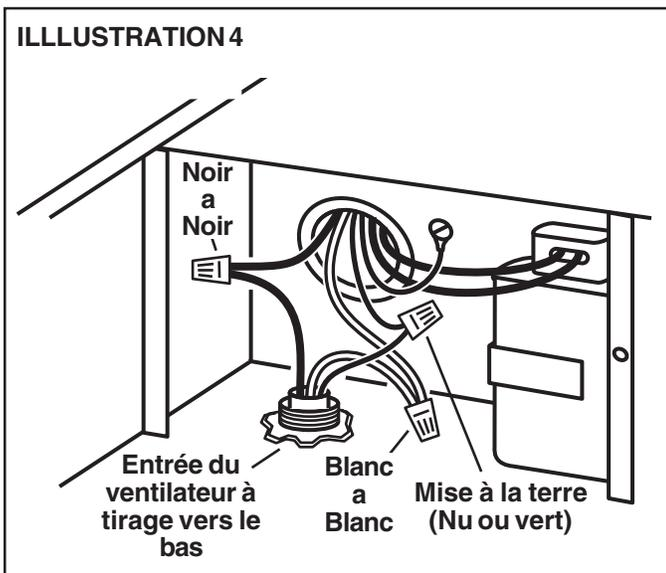
6. Effectuez les branchements électriques en utilisant le connecteur convenant au type de câblage utilisé. Branchez les fils noirs ensemble, les fils blancs ensemble, et le fil vert ou le fil dénudé avec le fil vert. Reportez-vous à la Figure 4.
