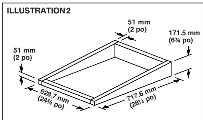
5. Pour la pose sur un toit plat, construisez un cadre porteur pour supporter le ventilateur en vous assurant que la pente minimale est de 2/12. Reportez à la figure 2. L'extrémité du conduit d'évacuation du ventilateur ne doit pas être orientée dans la direction des vents dominants.
