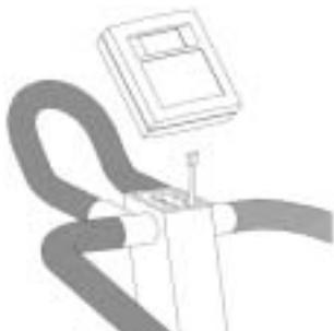
Ouvrir le protège-piles au dos du compteur et y mettre les piles (2 piles 1,5 V AA) en respectant la disposition des pôles + et - indiquée au fond du boîtier. Brancher le fil venant du montant vertical sur la prise au dos de l'unité des compteurs. Pousser l'unité des compteurs dans sa position finale. **ATTENTION !** Veuillez à ce que le fil ne reste pas coincé.
