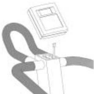
Abra la tapa de la caja de las pilas que está detrás de la del contador y ponga dos pilas AA de 1,5 V, respetando la polaridad (+ y -). Enchufe el cable del contador en el conector que hay en la
