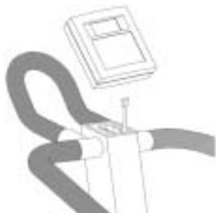
Avaa paristokotelon kansi mittarin takapuolelta ja aseta paristot (2 x 1.5 V AA) koteloon sen pohjassa olevien + ja - merkkien mukaisesti. Yhdistä pystyputken yläpäästä tulevan johdon liitin mittarin pohjassa olevaan pistokkeeseen. Työnnä mittari paikalleen pidikkeeseen. **TÄRKEÄÄ!** Varo ettei mittarin johto jää puristuksiin.
