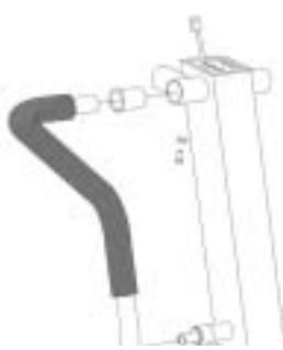
Pase el casquillo y el extremo superior del manillar izquierdo por el montante que hay en el extremo superior del bastidor vertical. Pase el extremo inferior del manillar por el separador. Sujete la parte superior del manillar con un perno de cabeza avellanada M8x20 y una arandela blocante, apretándolo con la llave hexagonal de 5 mm. Coloque el manillar derecho siguiendo el mismo procedimiento.
