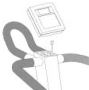
Deckel des Batteriefachs an der Rückseite der Elektronikanzeige öffnen und die Batterien (2 x 1,5 V AA) unter Berücksichtigung der Polarität (+/-) einsetzen. Das vom Hauptprofil kommende Kabel in die Buchse am Boden der Elektronikanzeige einstecken. Die Elektronikanzeige in die Halterung am Hauptprofil stecken. **BITTE BEACHTEN!** Darauf achten, dass das Elektronikanzeigenkabel nicht eingeklemmt wird.
