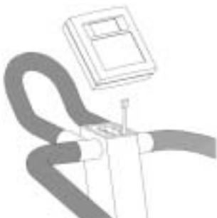
Öppna batterifackets lock på baksidan av mätaren och lägg in batterierna (2 x 1,5 V AA). Ge akt på + och -markeringarna. Koppla ihop kabeln som kommer från huvudprofilen med stickkontakten i mätarens botten. Skjut mätaren på sin plats i hållaren. OBS! Se till att kabeln inte kommer i kläm.
