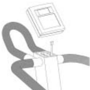
Aprite lo sportellino ed inserite due batterie 1.5 V AA secondo i segni + e -. Connettete lo spinotto del cavetto sul retro del pannello e fissate il manubrio sul suo sostegno facendolo scorrere nella guida. **ATTENZIONE!** Assicuratevi di non danneggiare il cavetto.
