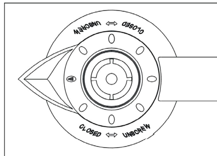
3. Pour retirer le couvercle, placez la flèche vers la position dévissée (Unscrew).
