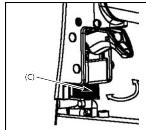
4. Après chaque réglage, s'assurer que le mouvement de la gâchette et du mécanisme de déclenchement par contact (WCE) puisse s'effectuer vers le haut ou vers le bas sans difficulté.
