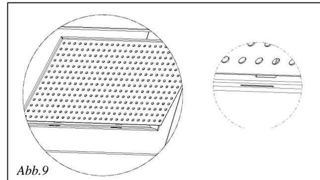
Die Filter herausziehen, indem man nach oben zieht. (Abb. 9).
