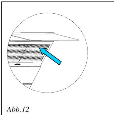
Die Filtermatten drehen, bis sie an der Dunstabzugshaube anliegen.
