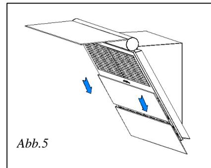
Die Glasscheibe die Führungsschienen der Stifte entlang hinuntergleiten lassen (Abb.5 und Abb.3.2)
