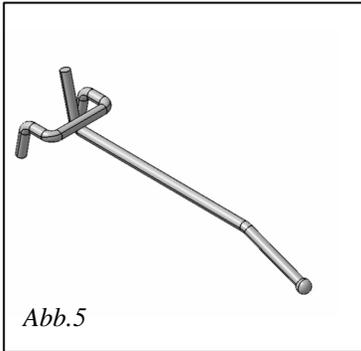
Zur Entnahme der Filtermatten muß der beiliegende Schlüssel (Abb. 5) verwendet werden.
