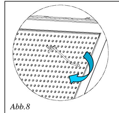
Den Schlüssel nach unten drehen und gleichzeitig ziehen (Abb.8).
