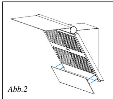
Die Glasscheibe mit der Markenaufschrift SMEG an die Dunstabzugshaube anlegen und die vier Stifte in die entsprechenden Öffnungen stecken (Abb.2).
