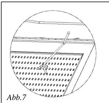
Den Schlüssel so in den oberen Teil des Filters stecken, daß die Gabeln des Schlüssels in die Öffnungen des Filters einhaken . (Abb.7) .
