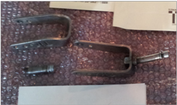
図6 破損部品（キャスターフォーク：前輪部）（(3)関連）
