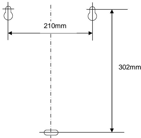
※取り付け位置は付属の取付原寸図を利用し、ネジを仮固定することもできます。
