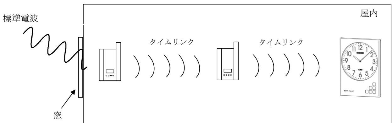
■ 長波受信器SLR-201 と タイムリンクプロ中継器SW-302 を使用
