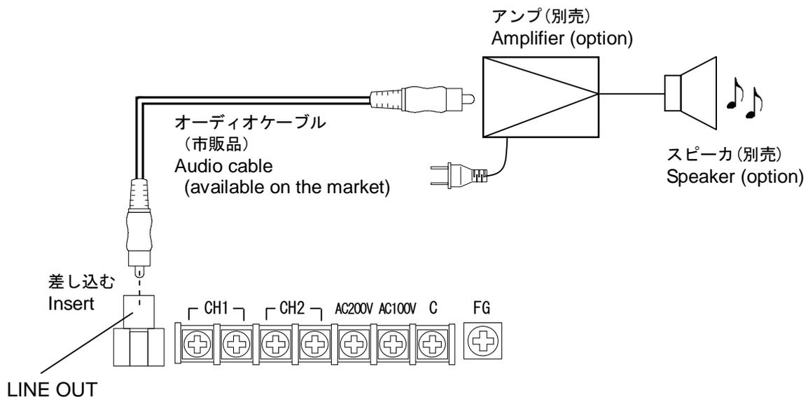
● アンプの入/切をタイマー制御する場合/ ON-OFF control of amplifier by timer
