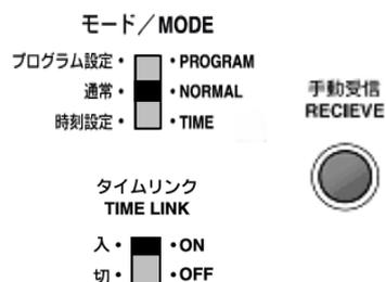
**モード**スイッチが**通常**中に**手動受信**ボタンを押すことにより、直ちにタイムリンクを受信させることができます。
