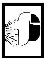
LES RAYONS LUMINEUX DE L'ARC ÉLECTRIQUE PEUVENT ENDOMMAGER VOS YEUX ET PROVOQUER DES BRÛLURES CUTANÉES!
