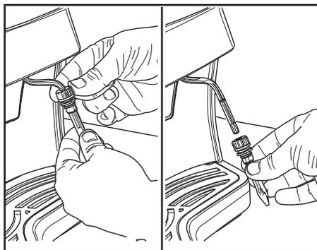
Allentare la ghiera e sfilare la parte interna del pannello. Dopo averlo lavato accuratamente, rimontarlo avendo cura d'inserirlo come mostrato in figura.
