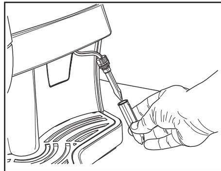
Den äußeren Teil des Pannarellos unter laufendem Wasser reinigen.
