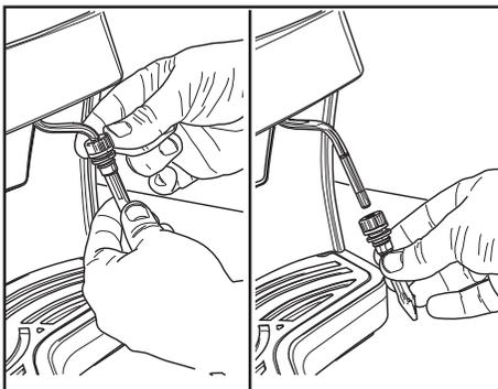
Die Nutmutter lösen und den inneren Teil des Pannarellos herausnehmen. Nach der sorgfältigen Reinigung wird er wieder korrekt eingesetzt, wie in der Abbildung gezeigt.
