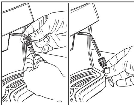
Desserrer la bague et retirer la partie interne du pannarello. Après l'avoir soigneusement nettoyée, remonter la bague en prenant soin de l'insérer conformément à la figure.
