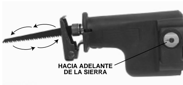
Figura 2 – Movimiento de la sierra cuando la palanca apunta hacia la izquierda
