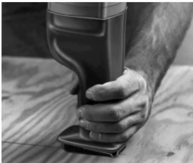
Figure 7 – Manière appropriée de tenir la scie lors de la coupe du bois
