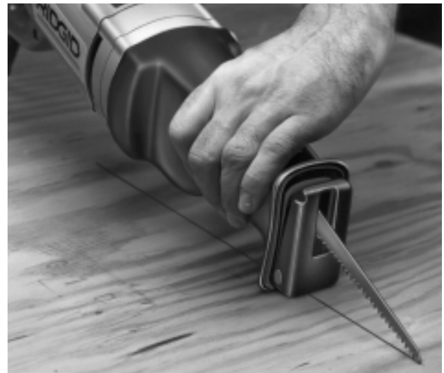
Figura 6 – Inicio de un corte de inmersión
