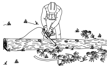
Figura 12 - Trozado del tronco completamente apoyado en el suelo
