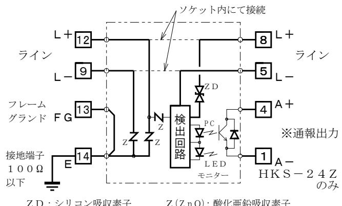
ZD : シリコン吸収素子      Z (ZnO) : 酸化亜鉛吸収素子
