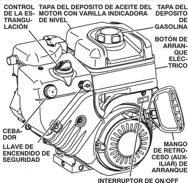
**NOTA:** TODAS LAS PARTES SE MUESTRAN EN SU POSICIÓN TÍPICA. LA POSICIÓN REAL PUEDE CAMBIAR SEGÚN EL MOTOR DE SU UNIDAD.
