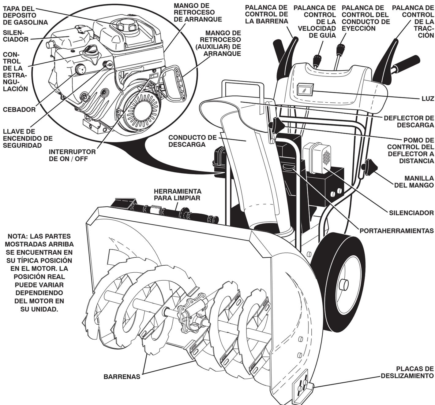
NOTA: LAS PARTES MOSTRADAS ARRIBA SE ENCUENTRAN EN SU TÍPICA POSICIÓN EN EL MOTOR. LA POSICIÓN REAL PUEDE VARIAR DEPENDIENDO DEL MOTOR EN SU UNIDAD.
