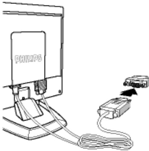
**Nota:** Se si utilizza un Apple Macintosh, è necessario collegare lo speciale adattatore Mac a un'estremità del cavo del segnale del monitor.
