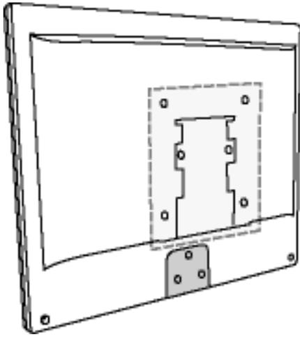
**Nota:** Questo monitor supporta un'interfaccia di montaggio conforme VESA da 100 mm x 100 mm.
