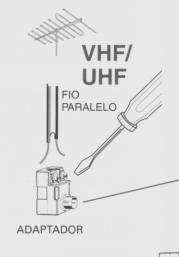
ENCAIXE PARA ANTENA INTERNA VHF (\*)
