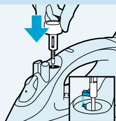
**I** Sett dampkontrollnålen tilbake ved å sette nålpinnen nøyaktig midt i hullet og tilpasse den lille kanten på siden av nålen i sporet. Sett dampkontrollknappen i posisjon O.
