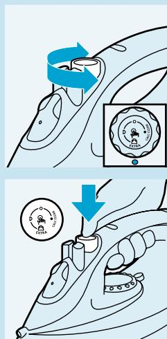
Fungsi ini memberikan uap ekstra untuk menghilangkan kusut atau lipatan yang benar-benar membandel.
