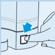
**4** Volte a colocar o reservatório sobre a base. Pressione para fixar bem.
