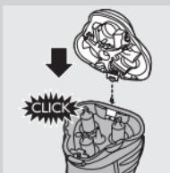
如果剃须刀头部件从剃须刀上脱落，可很容易地装回。方法是将铰链插入胡茬储藏室边的槽中，将其推到位，直到锁定到位（可听到咔嗒声）。
