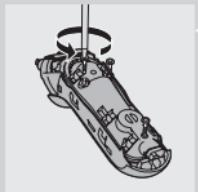
**5** 拧开密封电源部件中的三个螺丝。
