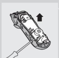
**6** 用螺丝刀将密封电源部件的后面板取下。
