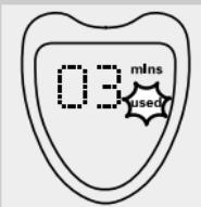
Wenn Sie den Rasierer ausschalten, werden die abgelaufenen Minuten angezeigt. Der Text "mins used" erscheint in der Anzeige, wobei das Wort "used" (abgelaufen) blinkt.
