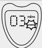
► Wanneer u het scheerapparaat uitschakelt, toont het scherm het gebruikte aantal scheerminuten. Tevens verschijnt de tekst 'mins used', waarvan het woord 'used' knippert.
