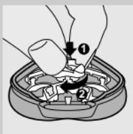
**4** Enlevez les têtes de rasage et placez les nouvelles têtes de rasage de telle façon que les parties avec les petits trous soient orientées vers le milieu dans l'unité de rasage.
