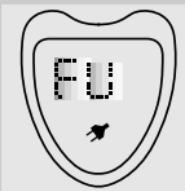
Sobald der Akku voll geladen ist, wird das Steckersymbol angezeigt. Alle 9 Sekunden läuft das Wort "VOLL" (Full) über die Anzeige.
