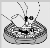
**1** Abra a unidade de corte, rode o anel para a esquerda (1) e remova a armação de retenção (2).
