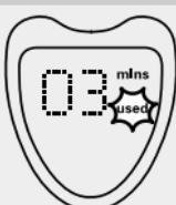
► Quando spegnete il rasoio, sul display appare il numero di minuti utilizzati. Viene visualizzato il testo "mins used" (la parola "used" lampeggia).
