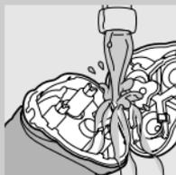
**3** Limpie la unidad afeitadora y la cámara de recogida del pelo enjuagándolas durante algún tiempo bajo el agua caliente del grifo.
