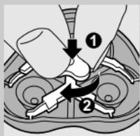
**5** Coloque de nuevo el marco de retención en la unidad afeitadora, presione la ruedecita (1) y gírela en el sentido de las agujas del reloj (2).
