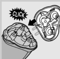
haya aflojado y que no muestre ninguna grieta o deterioro. Si el muelle bisagra está adecuadamente fijado, la unidad afeitadora podrá volver a ponerse de nuevo fácilmente en la afeitadora. Sin embargo, si el muelle bisagra se ha aflojado, está agrietado o deteriorado, póngase en contacto con su distribuidor Philips o con el Servicio de Asistencia Técnica Philips más cercano para evitar que la afeitadora sufra daños.
