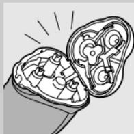
**5** 再一次打開電鬚刀組並保持開啓，讓電鬚刀完全晾乾。
