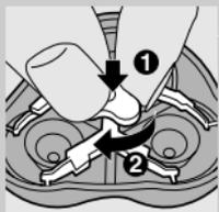
**5** Kembalikan rangka penahan ke dalam unit pencukur, tekan roda (1) dan putarkan ke arah jam (2).
