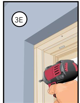
**MAKE SURE THE FLANGE REMAINS PRESSED FIRMLY AGAINST THE WALL SURFACE WHILE PLACING SHIMS AND FRAME SCREWS**
