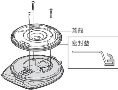
卸下三支螺釘，取下蓋殼，更換密封墊。
