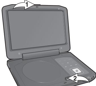
Deslice el INTERRUPTOR DE ENCENDIDO a la posición de ON para encender la unidad; el indicador de CORRIENTE se iluminará. (Asegúrese de que el interruptor de Entrada/Salida de AV esté en la posición de OUT (salida). De lo contrario, el display no mostrará una imagen.)
