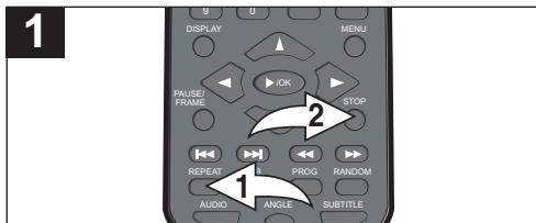
Presione el botón de REPETIR ① para alternar entre las siguientes opciones: SENCILLO (reproducirá el archivo seleccionado una vez y luego se detendrá), REPETIR UNO (se repetirá un archivo seleccionado continuamente hasta que presione el botón de DETENER ②), REPETIR CARPETA (se repetirá la carpeta seleccionada continuamente hasta que presione el botón de DETENER ②) o CARPETA (reproducirá la carpeta seleccionada una vez y luego se detendrá).
