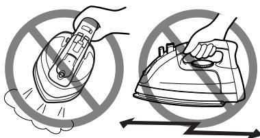
Ces mouvements peuvent provoquer une sortie d'eau chaude par l'orifice de remplissage, et éventuellement des brûlures.
