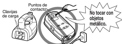
Al tocar los puntos de contacto con algún alfiler o alambre puede causar un cortocircuito, choque eléctrico e incendio.
