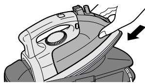
Inserte el depósito del agua hasta el fondo hasta que escuche un chasquito.
