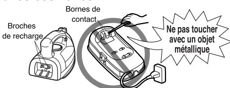
Tout contact d'un objet métallique avec les bornes de contact peut provoquer court-circuit, choc électrique ou incendie
