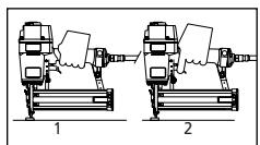
**ADVERTENCIA** Una herramienta que funciona de manera inadecuada no debe usarse. No active la herramienta a menos que esté colocada firmemente contra la pieza de trabajo.
