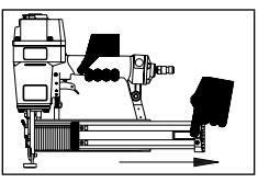
3. Introduire une rangée de clous Campbell Hausfeld ou l'équivalent (Voir Attachés) dans le chargeur. Les pointes des clous devraient reposer sur le rebord au fond du chargeur pendant le chargement. S'assurer que les clous ne sont pas sales ou endommagés.
