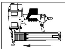
5. Toujours retirer tous les clous du chargeur avant de ranger la clouseuse. L'opération de déchargement s'effectue à l'inverse de l'opération de chargement mais il faut toujours débrancher le tuyau d'air comprimé AVANT le déchargement.
