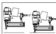
La gâchette doit être relâchée afin de rajuster l'outil avant d'enfoncer un autre clou.
