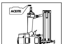
Agregue de 4 a 5 gotas de aceite sin detergente 30W en la entrada de aire. No use aceites con detergentes, aditivos de aceite, ni aceites para herramientas neumáticas. Los aceites para herramientas neumáticas contienen solventes que pueden averiar los componentes internos de la clavadora.
