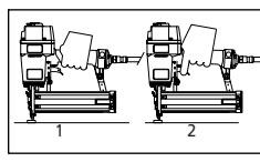
**AVERTISSEMENT** *Un outil qui ne fonctionne pas correctement ne doit pas être utilisé. Ne pas activer l'outil à moins qu'il soit placé bien fermement sur la pièce.*
