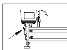
9. S'assurer que le mouvement de la gâchette et du mécanisme de déclenchement par contact (WCE) puisse s'effectuer vers le haut ou vers le bas sans difficulté.
