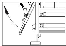
5. Enlever l'attache grippée en utilisant des pinces ou un tournevis si nécessaire.
