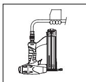
Mantenga las mangueras alejadas del calor, aceite y objetos punzantes. Reemplace cualquier manguera que esté dañada, débil o desgastada. Esto podría ocasionar heridas o daños a la herramienta.
