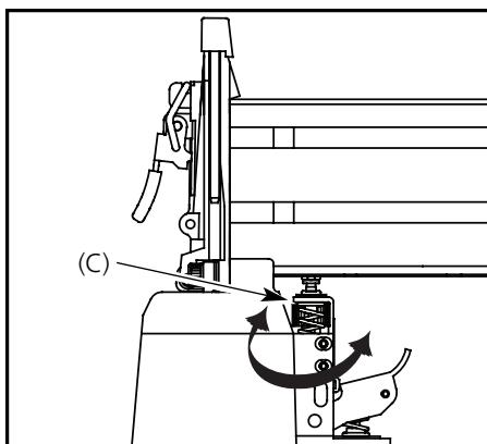
3. Pour enfourcher un clou plus profondément, tourner la roue (C) vers la droite jusqu'à la profondeur recherchée.
