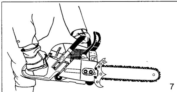
Maintenez fermement les poignées dans le creux de la main en les entourant entre le pouce et l'index (fig. 7). Cette position vous permet de mieux résister et absorber les forces de recul, de traction et de choc de recul de votre tronçonneuse sans qu'elle vous glisse des mains (cf. le point relatif aux forces de réaction). Assurez-vous que les poignées de la tronçonneuse sont en bon état et exemptes d'humidité, de poix, d'huile ou de graisse.
