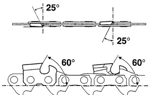
L'angle d'affûtage 25° doit être identique pour toutes les dents de rabotage. Des angles différents provoquent une marche irrégulière et rude de la chaîne, augmentent l'usure et aboutissent à des ruptures de chaîne!
