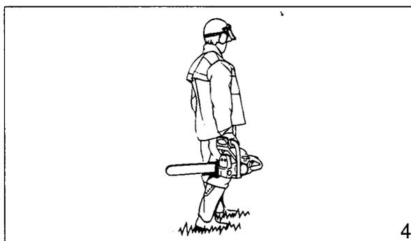
**Transport à la main:** lorsque vous portez votre tronçonneuse à la main, le moteur doit être arrêté et la tronçonneuse doit être en position correcte. La protection de la chaîne doit être mise et le guide doit être orienté vers l'arrière. Lorsque vous portez la tronçonneuse, le guide doit être derrière vous (fig. 4).
