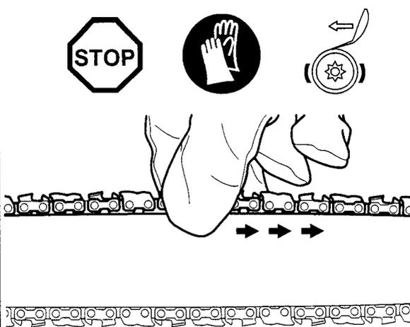
**Contrôle de la tension de la chaîne**
