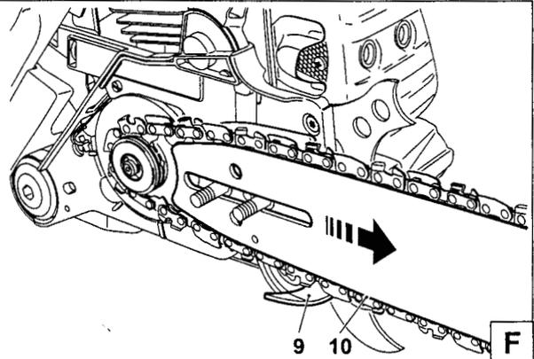
Aligner les trous de réception de la protection de la roue à chaîne (3) sur les goujons (11).
