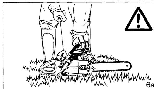
Posez la tronçonneuse sur un sol ferme ou sur une autre surface dure à un endroit dégagé. Assurez-vous que vous avez une position stable au sol et un bon équilibre. Passez le pied droit dans la poignée arrière et prenez fermement la poignée avant de la main gauche (fig. 6a).
