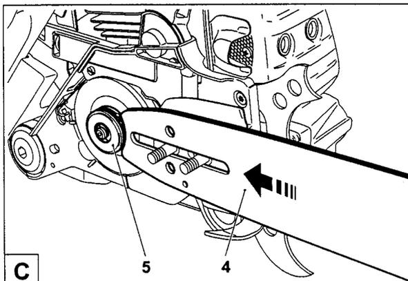
Poser la chaîne de sciage (4) et la pousser contre la roue à chaîne (5) dans le sens de la flèche.
