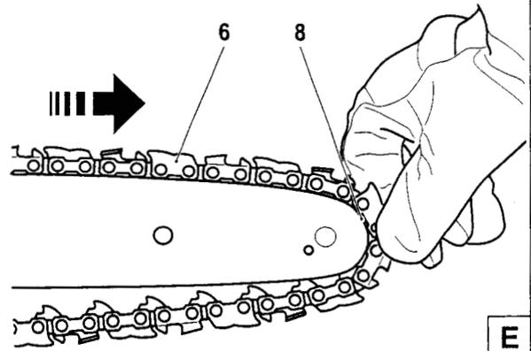
Poser la chaîne de sciage au-dessus de l'intercepteur de chaîne (9).
