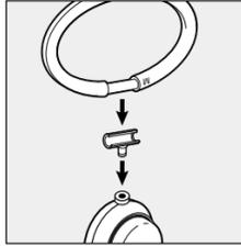
Para conectar la Abrazadera para la Oreja, separe el Gancho para la Oreja o la Cinta para la Cabeza. Conecte la Bisagra en Forma de T en la Abrazadera para la oreja hasta que entre completamente. Empuje el soporte de la Bisagra en Forma de T para que entre en el soporte del auricular.
