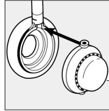
Para conectar la Cinta para la Cabeza, separe la Abrazadera o el Gancho para la Oreja. Alinee la muesca del anillo de la Cinta para la Cabeza con el soporte del auricular (parlante) y métalo en su lugar ejerciendo presión hasta que entre completamente.
