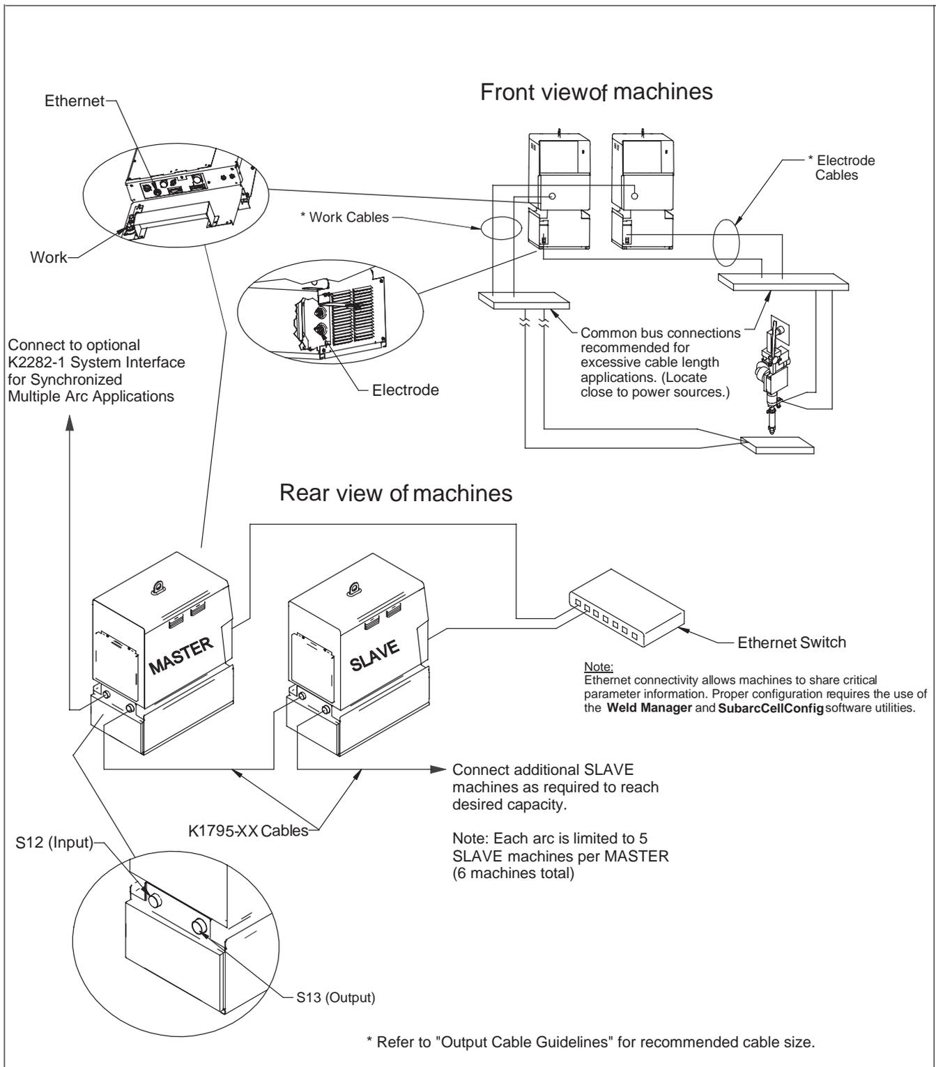
**STEP BY STEP INSTALLATION CHECKLIST****EXTRA CAPACITY PARALLEL CONNECTION**
