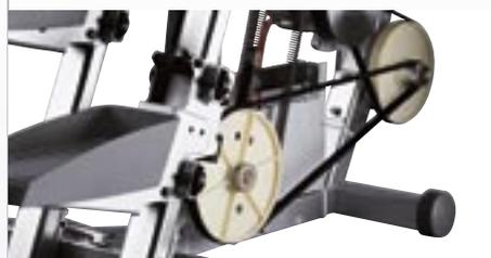
Le système d'entraînement par courroie Kevlar Carbone offre une grande fluidité de fonctionnement. Silencieux et fiable, il ne requiert aucun entretien.
