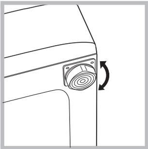
2. Yerleştirilecek zemin tam düz değilse çamaşır makinesinin vidalı ön ayaklarını sıkarak veya gevşeterek dengeyi sağlayınız (bkz. şekil); eğim açısı, makinenin üst tezgahına göre 2° den fazla olmamalıdır.
