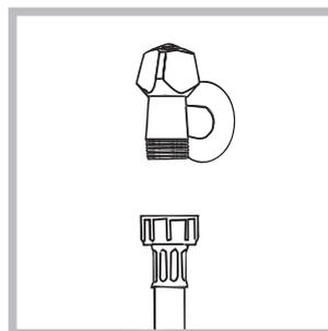
1. Підключити живлячий трубопровід, прикрутивши його до крану холодної води за допомогою шуцера з газовою різьбою 3/4 (див. малюнок). Перед підключенням спустіть воду, доки вона не стане прозорою.
