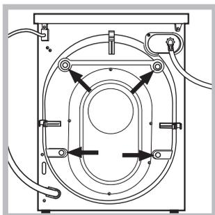
3. Видаліть 4 гвинти для захисту під час транспортування та гумову шайбу з відповідною прокладкою, що знаходяться у задній частині (див. малюнок).
