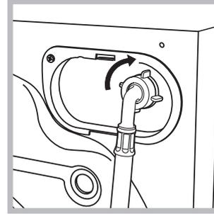
2. Besleme hortumunu arka kısımda üst sağ köşedeki su girişine vidalayarak çamaşır makinesine takınız (bkz. şekil).
