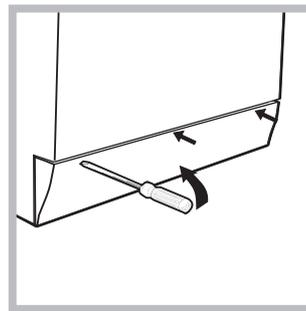
1. αφαιρέστε το ταμπλό κάλυψης στο πρόσθιο πλευρό του πλυντηρίου με τη βοήθεια ενός κατασαβιδιού (βλέπε εικόνα).
