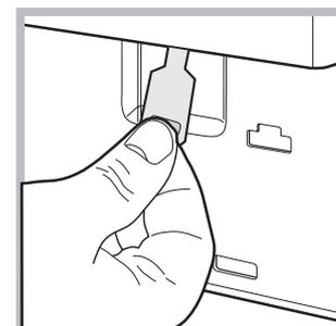
4. За допомогою вказаного на малюнку язичка тягніть пластмасову тягу з упору назовні, аж доки її не буде звільнено; потім протягніть її донизу, одночасно відкриваючи дверцята.
