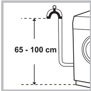
Підключіть зливний шланг, не згинаючи його, до каналізаційного каналу або до входу до такого каналу на стіні, на відстані від 65 до 100 см від підлоги;
