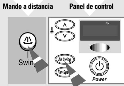
**Según la ubicación de la unidad en la habitación, puede ajustar la orientación de las guías del flujo de aire interiores situadas en la parte derecha de la unidad y, de este modo, incrementar la eficacia del acondicionador de aire.**
