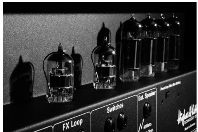
Abb.: QUAD EL 84, 2x 12AX7, 4x EL84
