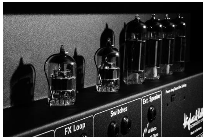
Fig.: QUAD EL 84, 2x 12AX7, 4x EL84
