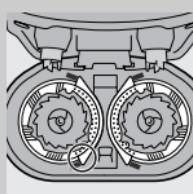
**5** 将固定架放回剃须刀头部件。按住轮子并向顺时针方向转动。
