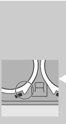
**5** Kembalikan rangka penahan ke dalam unit pencukur, tekan roda dan putarkannya menurut arah jam.
