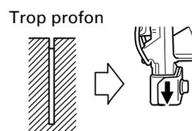
Si l'agrafe doit être clouée profondément, régler le levier-poussoir sur «bas», et si elle doit être clouée peu profondément, régler le levier-poussoir sur «haut».
