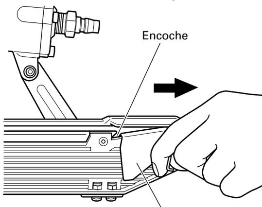
(2) Placer la bande d'agrafes sur le magasin. Vérifier que la bande d'agrafes glisse en douceur sur le magasin.
