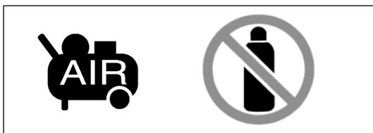
Ne jamais utiliser d'oxygène, de gaz combustibles ni aucun autre gaz en bouteille comme source d'alimentation du cloueur.
