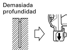
Para introducir la grapa profundamente, ajuste la pieza de la palanca de empuje a "down" (abajo), y para introducirla superficialmente, ajuste a "up" (arriba).
