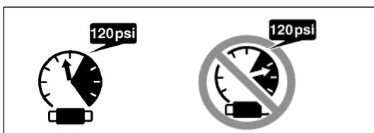
Ne pas dépasser la pression d'air maximale recommandée de 120 psi (8,3 bars, 8,5 kgf/cm<sup>2</sup>).
