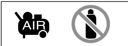
No utilice nunca bombonas de oxígeno, gases combustibles, etc. como fuente de propulsión de esta grapadora.
