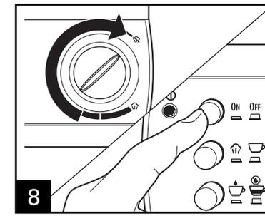
**8** Gire el marcador de control de vapor a NO VAPOR ⚡. Presione el botón de Encendido (la luz se apagará); luego el botón de selección de temperatura de nuevo para apagar la temperatura de vapor. Desconecte la unidad de la toma. Limpie la boquilla de espuma después de cada uso.
