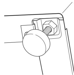
**REMARQUE :** pour réduire la vibration, les contre-écrous doivent être serrés.
