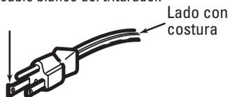
**NOTA:** Al ver el costado del enchufe eléctrico con el dispositivo de conexión a tierra en la parte superior, la hoja izquierda más larga se conecta con el cable identificado.
