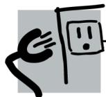
**PELIGRO:** La conexión incorrecta del sistema de polo a tierra puede resultar en el riesgo de una descarga eléctrica. Consulte con un electricista calificado o con un proveedor de servicios si tiene dudas de que el aparato esté correctamente conectado a tierra. No modifique el enchufe suministrado con el aparato si no encaja en el tomacorriente; haga que un electricista calificado instale un tomacorriente apropiado.
