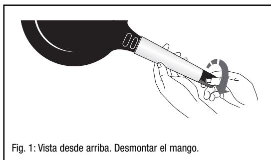
Fig. 1: Vista desde arriba. Desmontar el mango.
