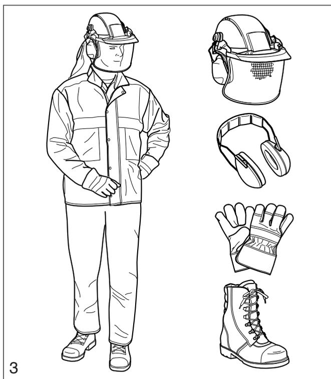
Pour travailler avec la tronçonneuse, il est important d'avoir une position stable au sol. Portez des chaussures montantes robustes munies de semelles antidérapantes. Il est conseillé de porter des chaussures de sécurité à embout acier.
