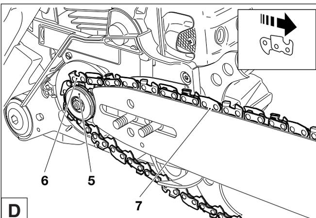
Poser la chaîne de sciage (6) sur le plateau (5). Introduire avec la main droite la chaîne de sciage dans la rainure de guidage supérieure du guide de la chaîne (7).
