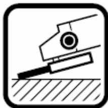
Lors de travaux de meulage, vous obtiendrez les meilleurs résultats en approchant l'appareil avec un angle de positionnement de 30° à 40°. Guider l'appareil de façon régulière et en exerçant une pression modérée. Ceci évite un réchauffement excessif de la pièce à travailler, elle ne change pas de couleur et il n'y a pas de stries.
