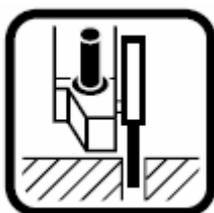
Lors de travaux de tronçonnage, ne pas exercer de pression, ne pas incliner, ni faire osciller. Travailler en appliquant une vitesse d'avance modérée adaptée au matériau. Ne pas freiner les disques de tronçonnage qui tournent encore en exerçant une pression latérale. L'important, c'est la direction dans laquelle on effectue le travail de tronçonnage. L'appareil doit toujours travailler en sens opposé ; en conséquence, ne pas guider l'appareil dans l'autre sens ! Sinon, il y a risque qu'il sorte
