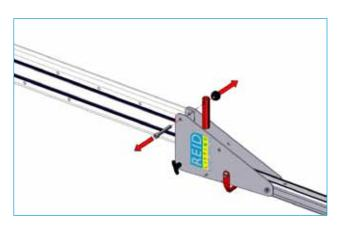
28. Déplacer le pied sur la poutre jusqu'à la position voulue. Réinsérer le boulon en serrant correctement l'écrou. Terminer le montage du portique comme indiqué aux étapes 8-10.
