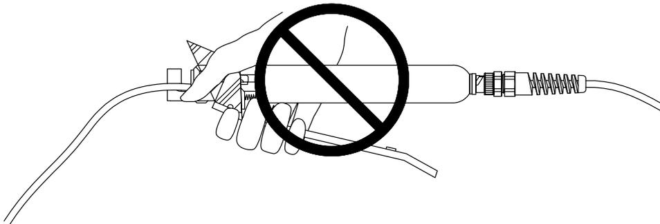
**Figure 2.4 Technique incorrecte de maintien de la tête de soudure**
