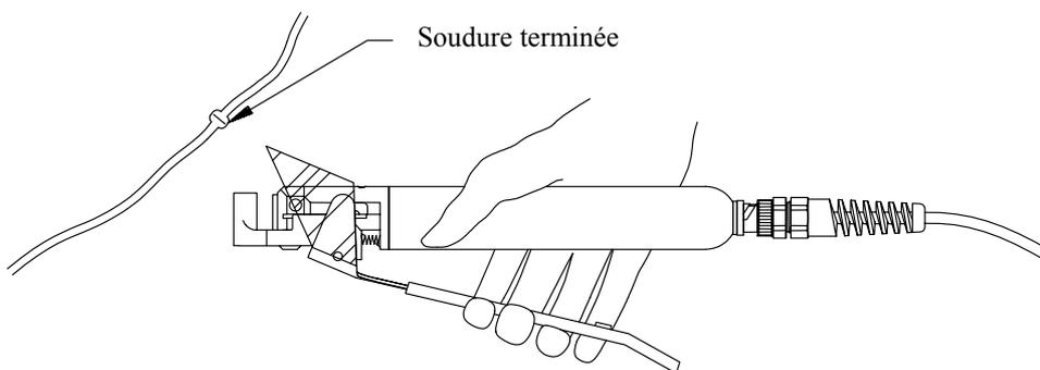
**Figure 2.6 Relâchement du levier de la tête de soudure après la fin de la soudure**
