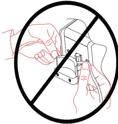
**Figure 2.8 Méthode de soudure incorrecte**
