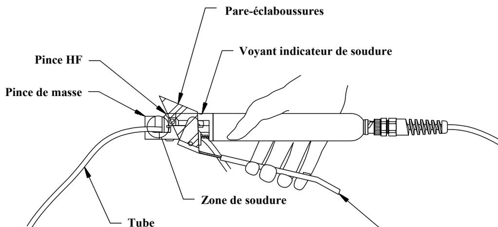
**Figure 2.3 Technique adéquate de maintien de la tête de soudure**
