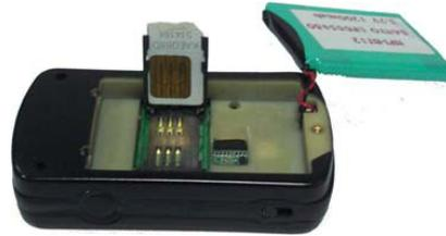
Avant refermeture, assurez-vous que la carte SIM est bien placée dans son logement et que les contacts sont correctement positionnés, autrement la carte SIM ne sera pas détectée correctement.
