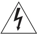
Le symbole d'un éclair dans un triangle équilatéral est prévu pour avertir l'utilisateur de la présence d'une tension dangereuse non isolée à l'intérieur du boîtier de l'appareil, qui est suffisamment forte pour provoquer une électrocution des personnes.
