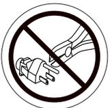
**Ne pas enlever la broche de masse sous peine de créer un risque électrique. Si besoin, installer un adaptateur à 3 broches approuvé sur une prise électrique à 2 broches. Si cet avertissement n'est pas respecté, un accident entraînant des blessures et des dommages pourrait survenir.**
