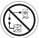
**Éviter toute blessure corporelle et dommage au produit. Ne pas connecter de rallonge au convertisseur c.a/c.c. ou au chargeur de batterie.**
