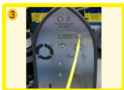
Connectez le flexible d'échappement de la vapeur (Ø 4 mm) et vérifiez qu'il est correctement inséré.
