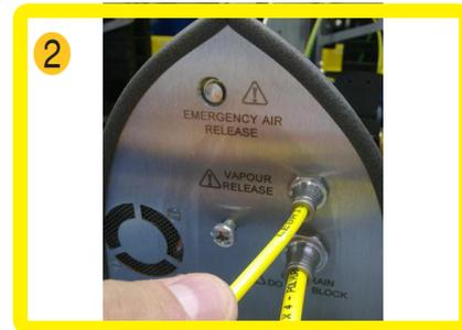
Retirez le flexible d'échappement de la vapeur ( $\varnothing$  4 mm) en tirant dessus tout en appuyant sur l'embout du connecteur. À ce stade, il se peut que vous constatiez une légère fuite.
