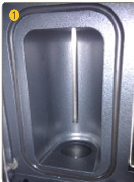
Ouvrez la porte et retirez le joint de porte. Utilisez l'isopropanol pour nettoyer l'intérieur de la rainure et l'intérieur de la porte, nettoyez toute trace de graisse silicone.
