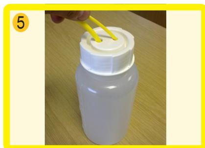
Insérez les deux flexibles (4 et 6 mm) dans le flacon. Veillez à conserver le flacon en position verticale lors du fonctionnement de l'icountBS afin d'éviter tout renversement.
