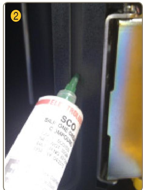
À l'aide d'une seringue, appliquez de la graisse silicone à la base de la rainure. NE PAS appliquer le produit sur les parois latérales de la rainure. Utilisez une brosse pour appliquer la graisse uniformément sur toute la base de la rainure.
