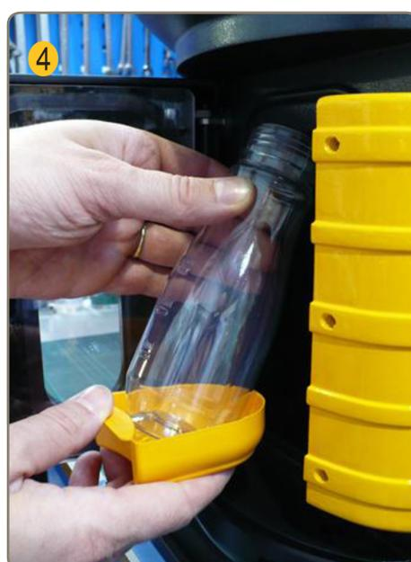
Tenez le bac récupérateur dans une main et le flacon légèrement incliné dans l'autre, puis insérez l'ensemble.
