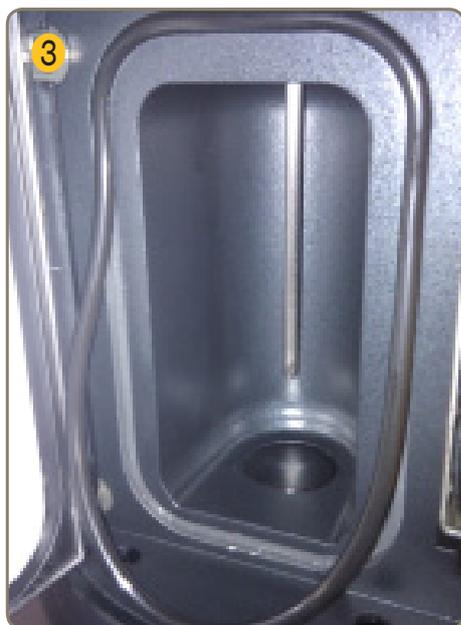
Insérez le nouveau joint torique de la partie supérieure. Assurez-vous qu'il se place de telle sorte que la ligne de moulage ne se trouve pas sur un plan de joint.
