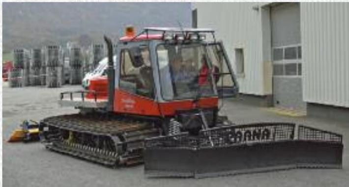
haute résistance ont été conçues en hauteur standard de 78 mm ou 65 mm pour les sols sensibles et à faible épaisseur de neige. Enfin en terme d'habitacle, cet appareil mise sur le confort et la sécurité avec une cabine monoplace ergonomique qui privilégie la visibilité panoramique pour le conducteur grâce à la largeur de ses baies vitrées. Alors que la fabrication continue d'être assurée dans les ateliers finlandais,
