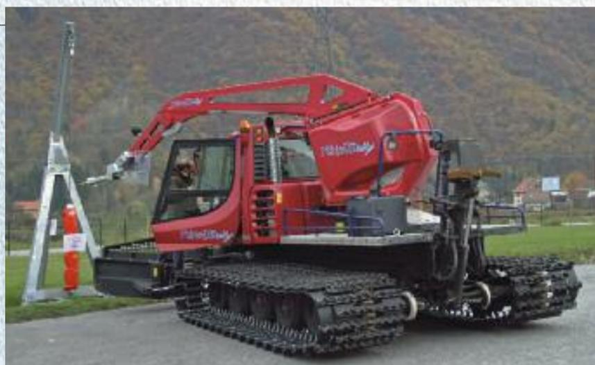
Le métier de dameur va changer avec Kässbohrer. Les conducteurs n'auront désormais plus à sortir de leur machine dans la nuit et le mauvais temps pour amarrer le câble du treuil à l'ancrage. La dernière innovation PistenBully propose aujourd'hui un procédé révolutionnaire d'attache à distance du câble de treuil adaptable à l'ensemble des machines treuils de la gamme PistenBully
