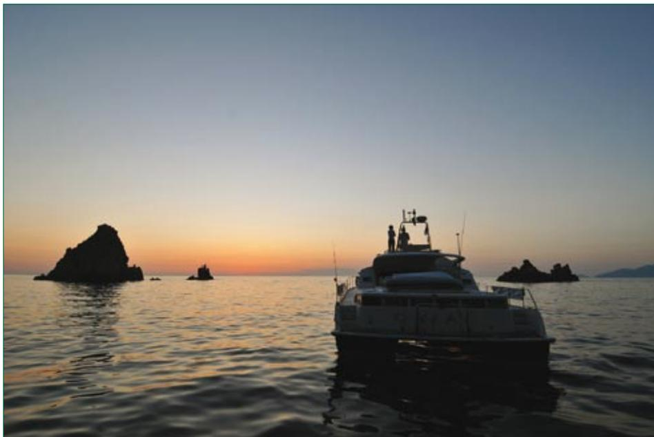
Les antennes, que l'on distingue sur ce contre-jour, sont positionnées au plus haut point du navire pour éviter les masques.
